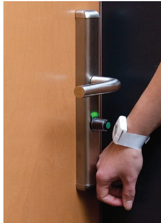
Der wie eine Armbanduhr zu tragende Patiententransponder öffnet Türen und besitzt Notruf- und Ortungsfunktionen. Bild: Syntron
